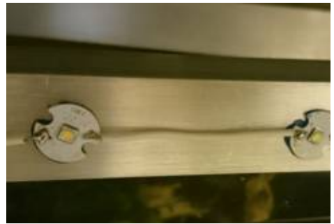
Abbildung 2: Fertig aufgeklebte und in Reihe verlötete LEDs.
