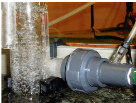
Anschluss mit Luft-Einmischung
