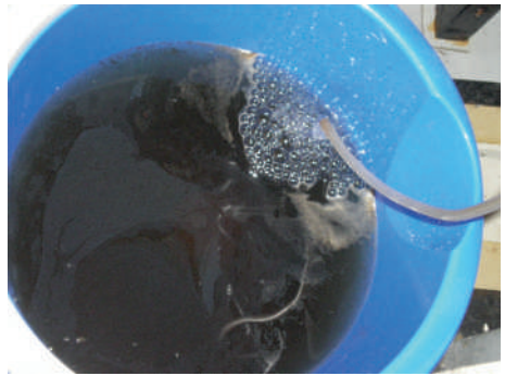
Abgelaufenes Floatat im Auffangeimer
